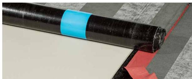
Verlegung der MOGAFIX KSK-D Uni auf Betondecke: Zur teilflächigen Verklebung, Entfernung der unterseitigen Ablösefolie. Zur vollflächigen Verklebung, zusätzlich Vent-Folienstreifen entfernen.
